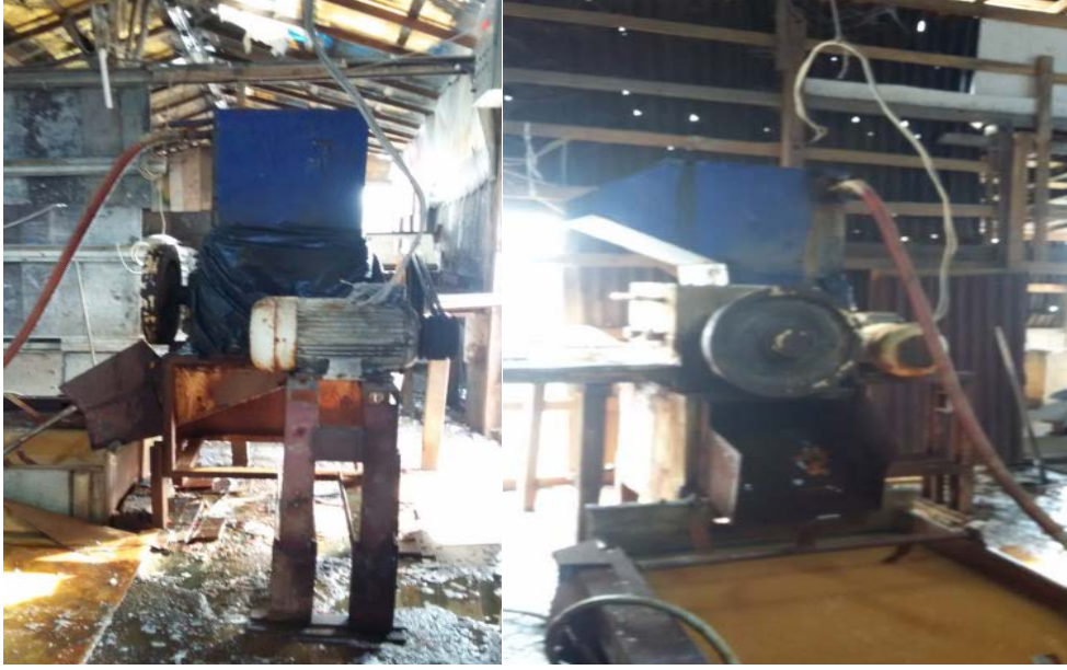
Şekil 3.10: Volanları Korumasız çalıştırılan Plastik Kırma Makinesi
