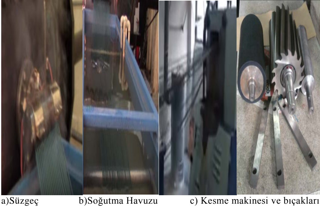
Şekil 4.15: Silindirik Tesbih Şeklinde Kesme Makinesinin Kısımları
