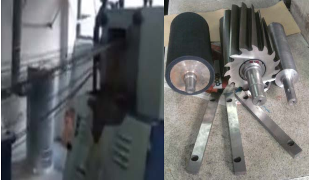
Şekil 2.29: Tesbih Biçimli kesme makinesi ve silindirik bıçak
