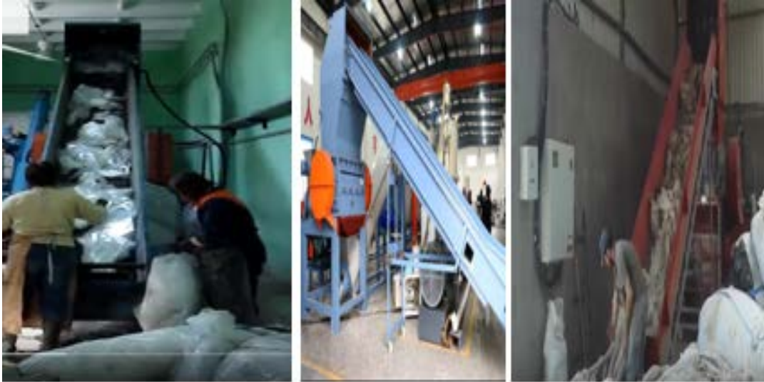
Şekil 4.21: Makineye taşıyıcı bant ile besleme
