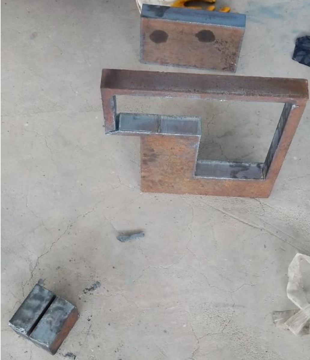
Şekil 3.11: Çelik Bloğun Oksii-Asetilen İle Kesilmesi
