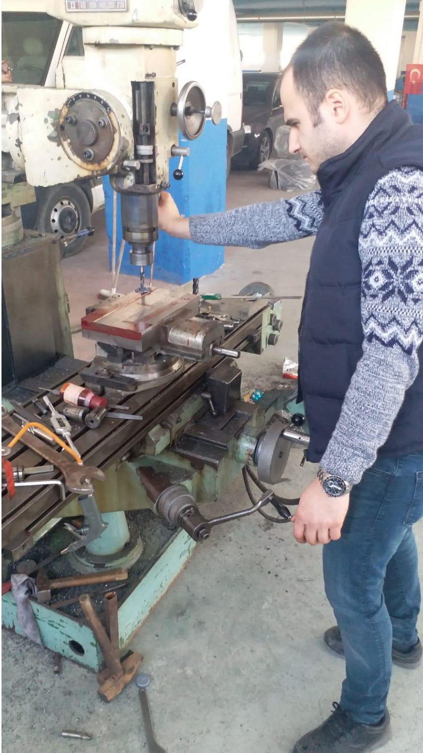
Şekil 3.15: Bağlantı Deliklerinin Açılması 1
