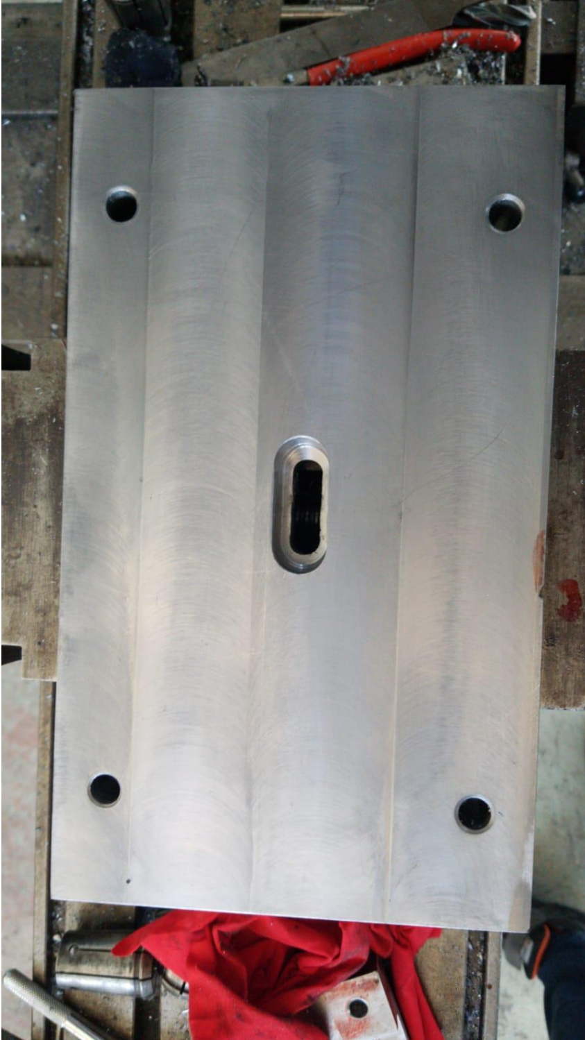
Şekil 3.17: Somun Tutucu Boşluğun İşlenmesi
