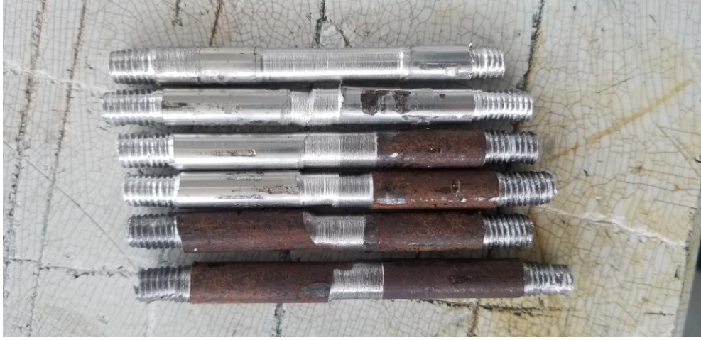
Şekil 4.8: Kaynağı Yapılmış Parçaların Çekme İşlemine Hazırlanması
