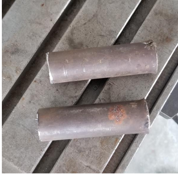
Şekil 4.2: İşlenecek Parçaların Kesilmesi
