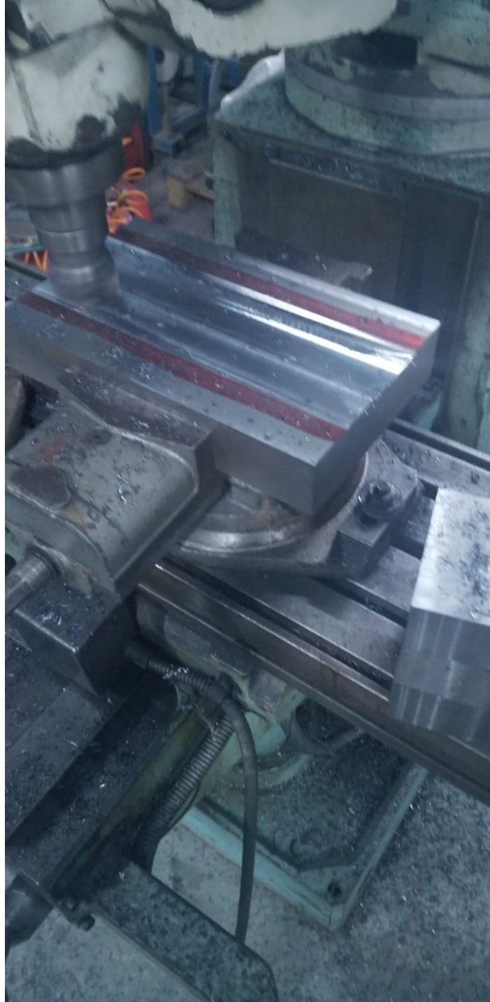
Şekil 3.14: Ana Tutucu Para Üzerine Hareket Kanalı Açılması
