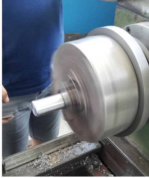
Şekil 4.4: Parça Yüzeylerinin Tornada Ölçülendirilmesi
