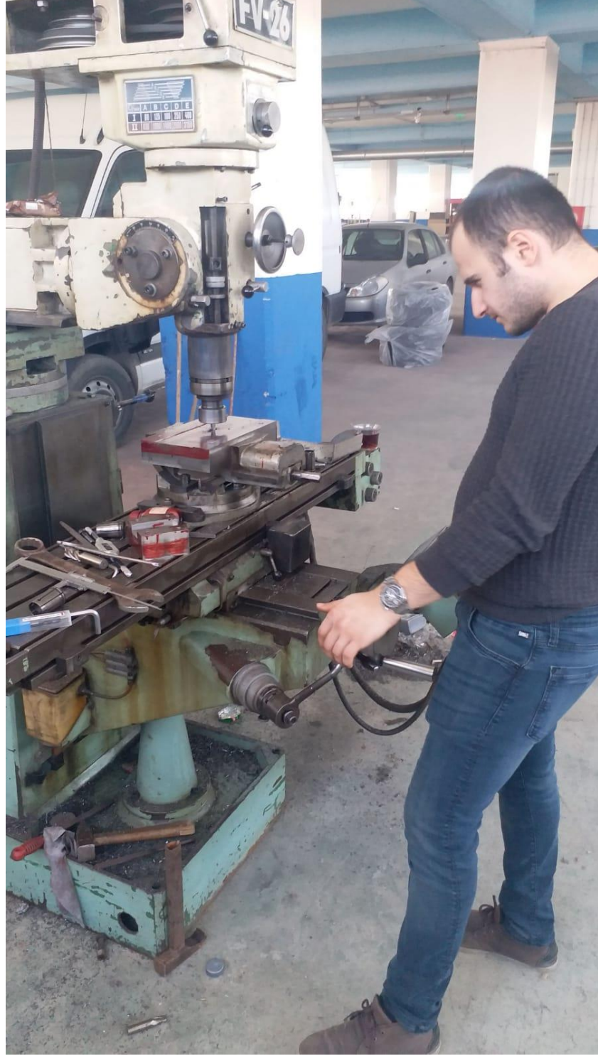
Şekil 3.16: Bağlantı Deliklerinin Açılması 2
