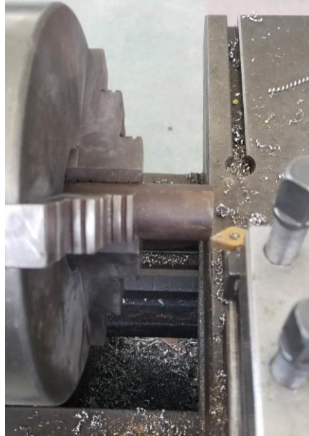
Şekil 4.3: Parça Boylarının Tornada Ölçülendirilmesi
