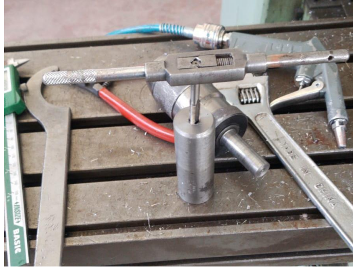
Şekil 4.5: Metrik Diş Çekimi
