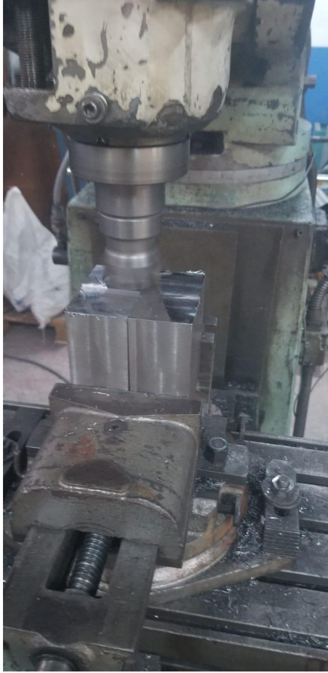
Şekil 3.12: Malzeme Yüzeylerinin Temizlenmesi 1
