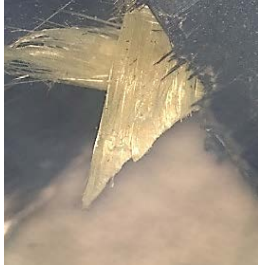
Şekil 6.13: 3 katlı numunenin kırılma alanının mikro görüntüsü
