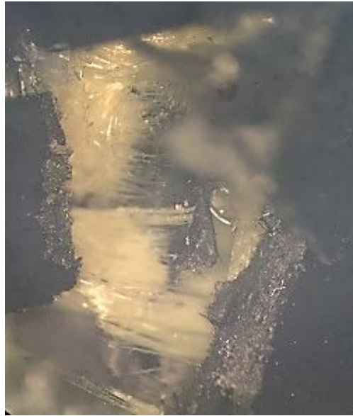
Şekil 6.15: 7 katlı numunenin kırılma alanının mikro görüntüsü
