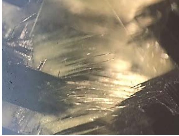
Şekil 6.14: 5 katlı numunenin kırılma alanının mikro görüntüsü
