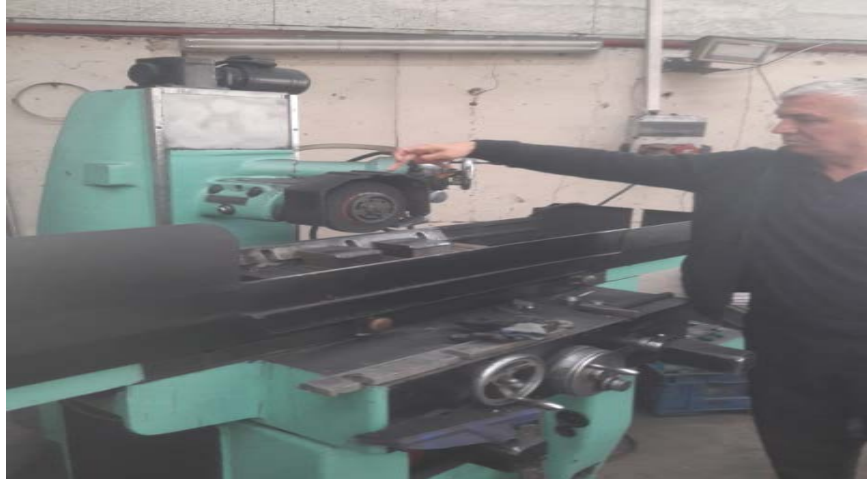
Şekil 2.45: Üniversal satıh taslama ile kırma bıçağı bilemesi
