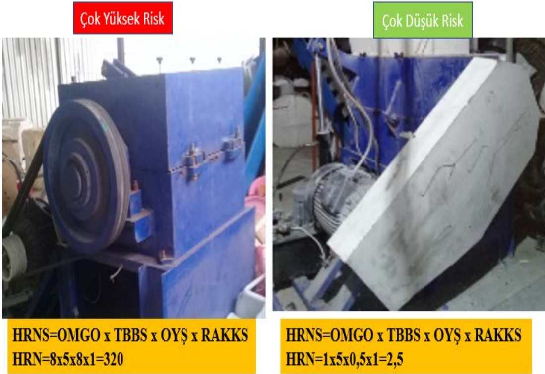
Şekil 4.6: Plastik kırma makinesi korumalı ve korumasız hali
