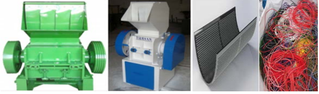
a) Kablo kırıcı(600)mm b) Kablo kırıcı(500)mm c) Hacim eleği d) Kablo
