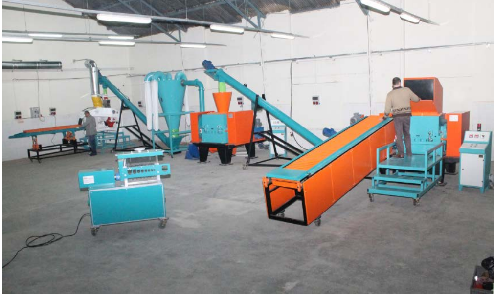
Şekil 2.2: Atık bakır kablo kırma ve ayrıştırma prosesleri
