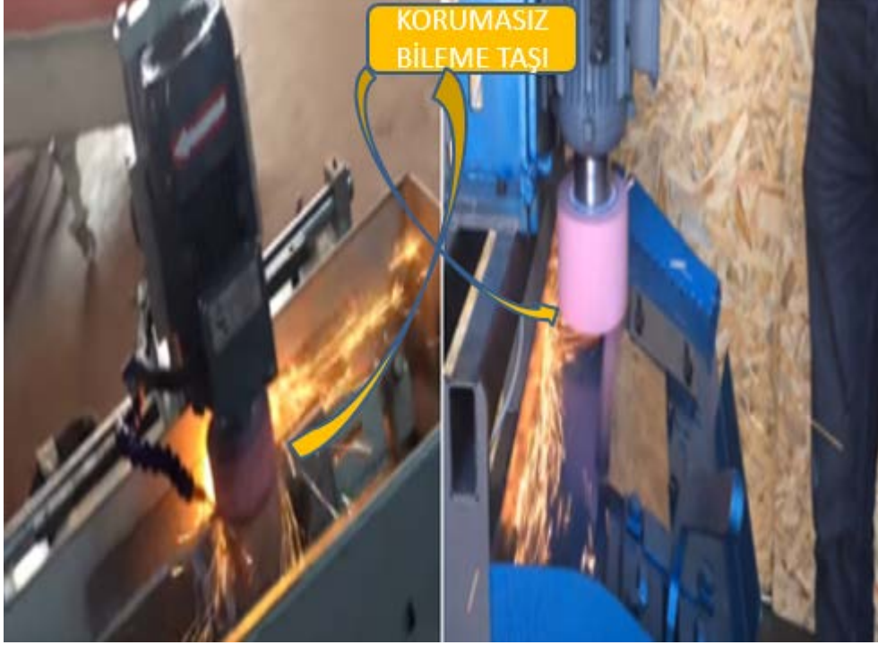
Şekil 2.43: Kıırma bıçağı bilemesi
