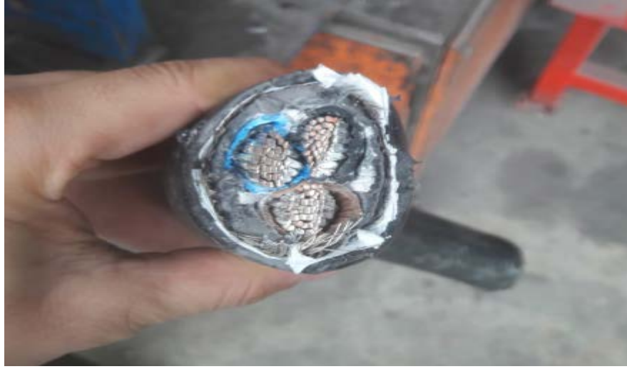
Şekil 2.5: Kompozit yapılı kablo
