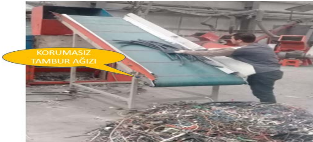
Şekil 2.11: Aktarma organın korumasız çalıştırılması
