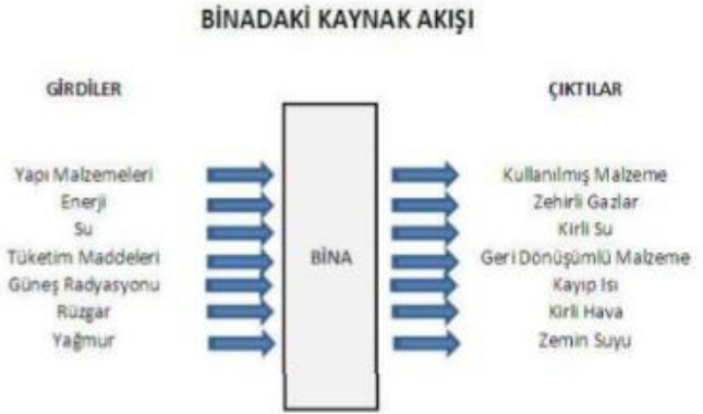
Şekil 9. Yapı sisteminde kaynak akışı (Sev, 2009)
