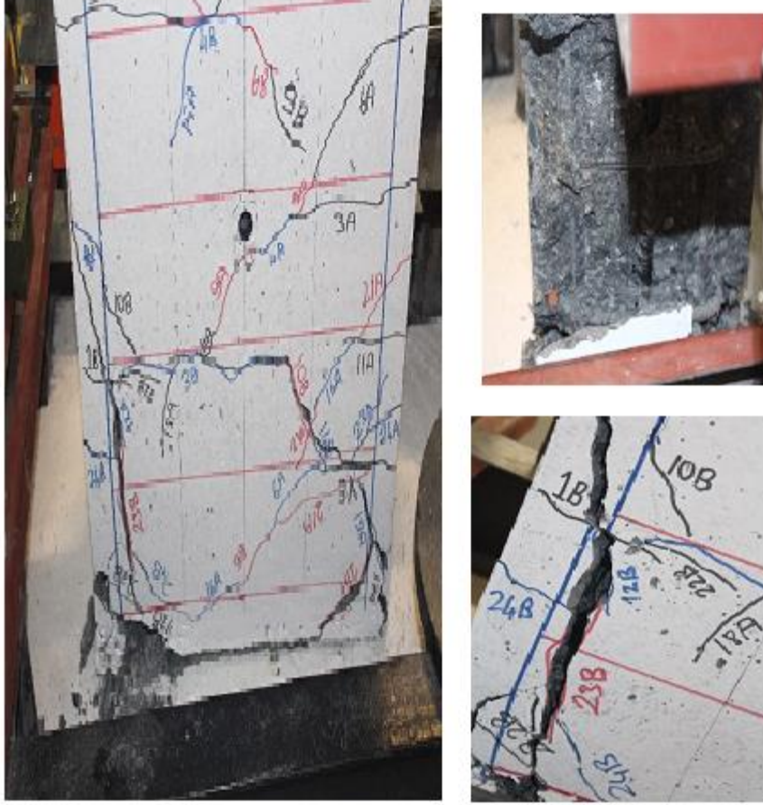
Şekil 3.2: KY 01-3.6 deney sonu hasar durumu
