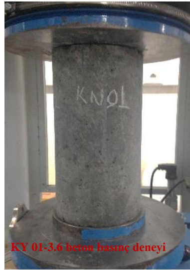
Şekil 2.2: KY 01-3.6 deney numunesi malzeme özelliklerine ait fotoğraflar
