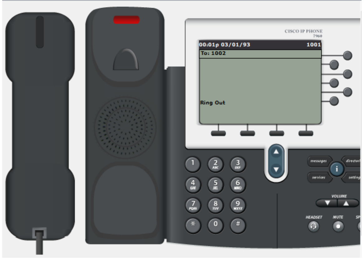
Şekil 5.7 1001 portlu IP telefonun 1002 portlu IP telefonuna ulaşması
