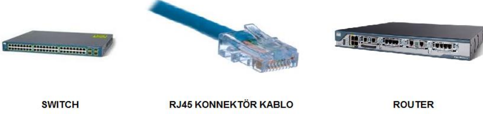
Şekil 1.1 Switch , RJ45 KONNEKTÖR KABLO , ROUTER
