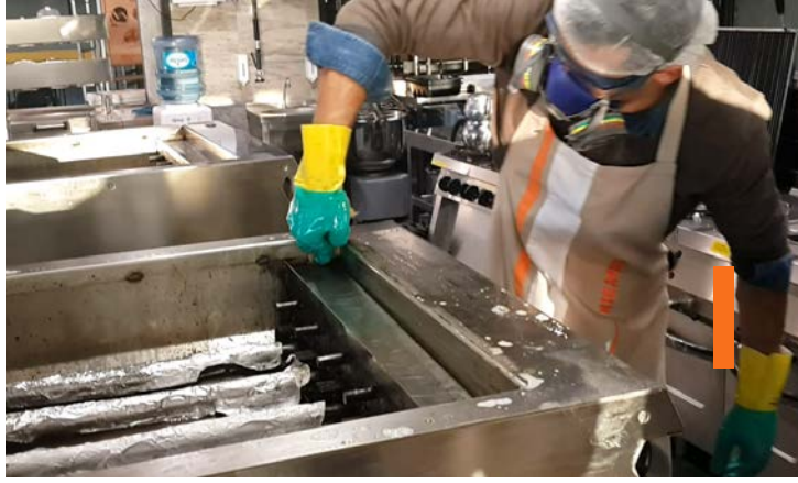
Şekil 4.5: Doğalgazlı ızgaranın güvenli temizliği
