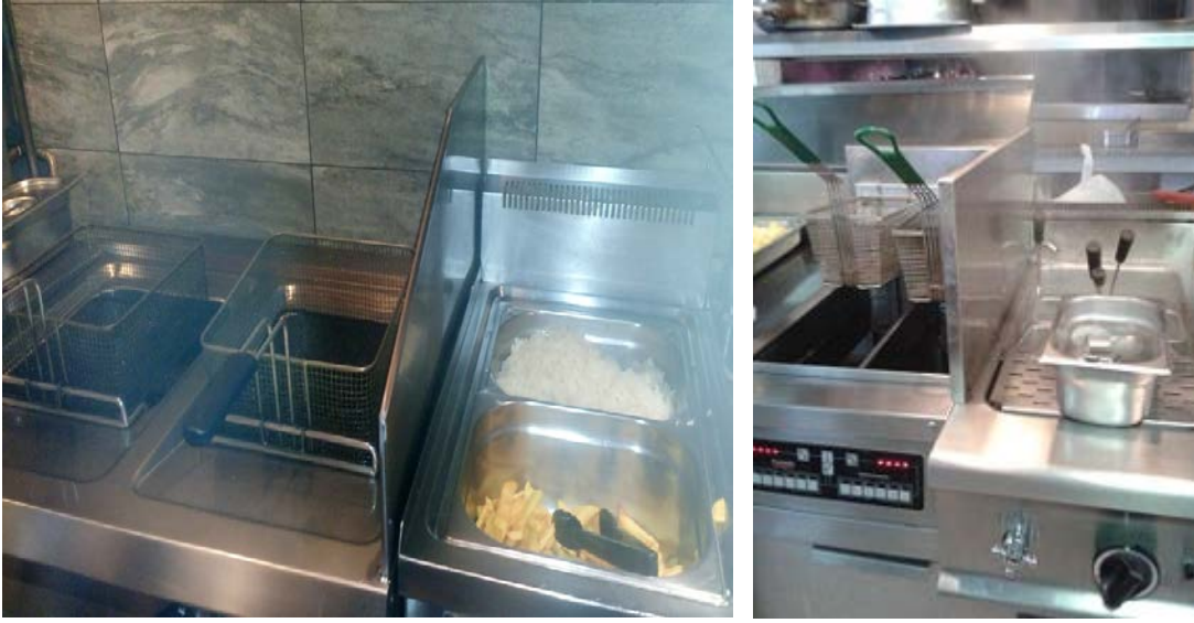
Şekil 5.10: Fritöz ile bainmarie arası paravan
