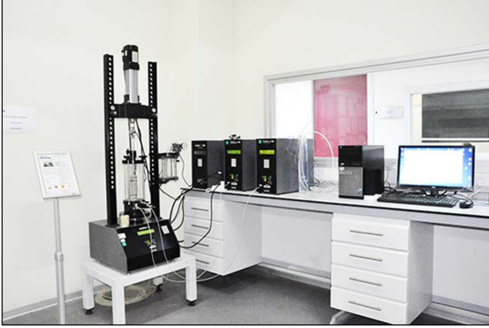
Şekil 2.1: Üç eksenli deney sistemi (İ.A.U. Zemin-Kaya Mekaniği Laboratuvarı)
