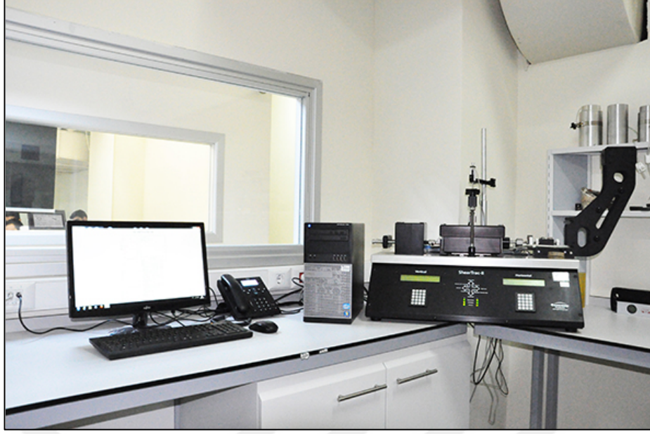
Şekil 2.2: Kesme kutusu deney sistemi (İ.A.U. Zemin-Kaya Mekanikği Laboratuvarı)
