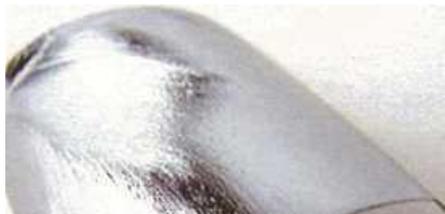
Şekil 1.4: Elli mikrometre kalınlığında silisyum dilimi. Bu dilim tekli kristal yapılu bir dilimden "kopartılarak" meydana getirildi.
