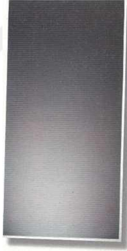
Şekil 1.17: ince film modüllerine mahsus tipik şerit görünümü, örnek: CdTe'li modül [First Solar]
