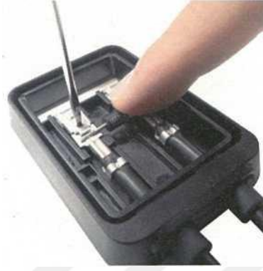
Şekil 2.22: Bir adet köprüleme diyotlu modül bağlantı kutusu [Multi-Contact]
