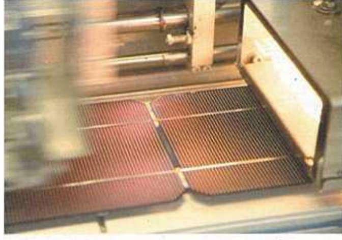
Şekil 2.5: Dizi otomatından bir görünüş [Solarwatt]
