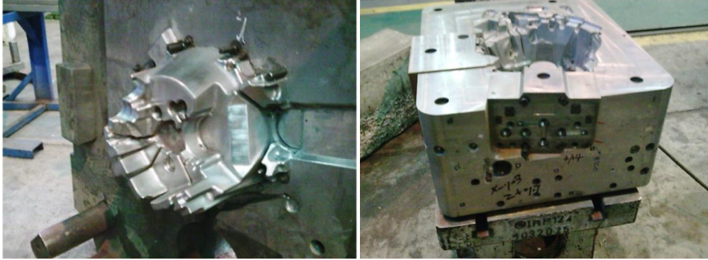
Şekil 6.15: Sabit taraf ve mobil taraf Debriyaj Mahfazası Kalıbı numunesinin tertibatı.
