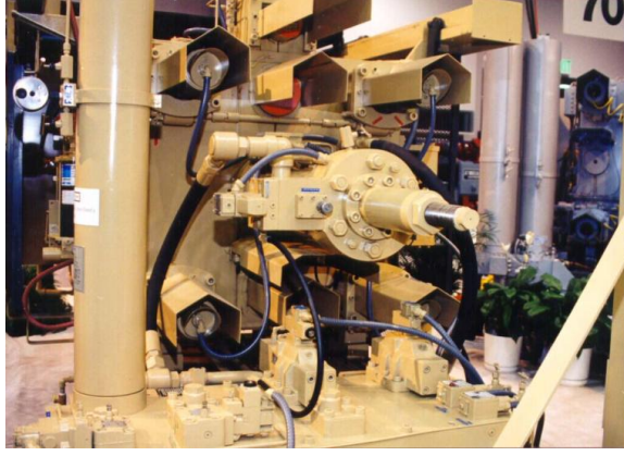
Şekil 2.5: Kalıp kapalı silindir (Operator Training Book ,10f3).
