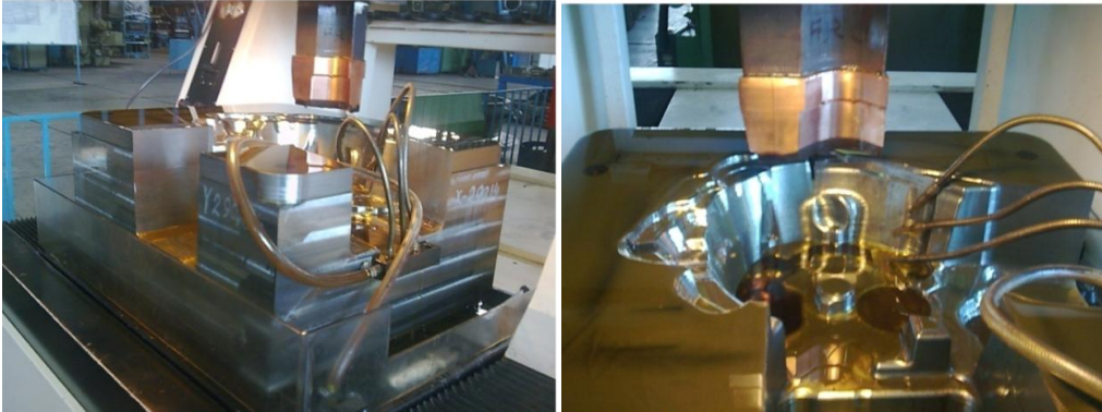
Şekil 6.6: Mobil Taraf Debriyaj Mahfazası Kalıbı numunesinin kıvılcımlanması.
