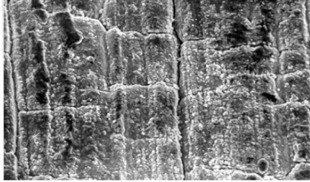
Şekil 3.4: SEM –Termal yorgunluk çatlaklarının mikro yapıları [1.2344(H13)]
