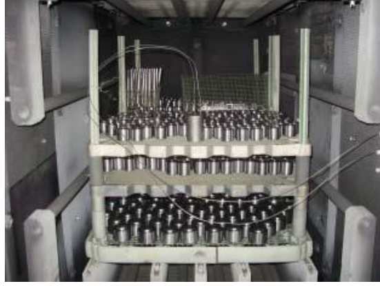
Şekil 6.20: Isıl çiftlerinin kullanımı, ısı işlemi esnasında farklı alanlardaki sıcaklığa bir genel bakış sağlar
