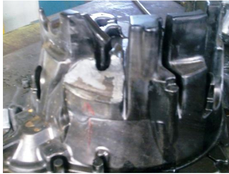
Şekil 8.6: Kalıbın sabit tarafı üzerinde kırık oluşmuştur TOOLOX44 (20,000 Döngü Testi)
