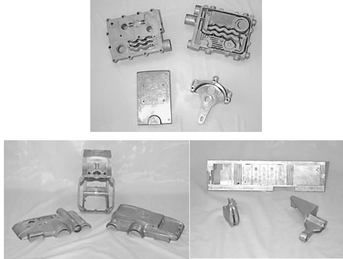
Şekil 1.2: Al, Mg, Cu esaslı ve Zn alaşım dökümlerin fotoğrafı (Operator Training Book ,10f3).
