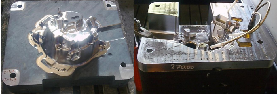
Şekil 6.26: Basınçlı döküm kalıp numunesi, 1.2343'e göre hazırlanmıştır (Naimi & Hosseini, January 2015).
