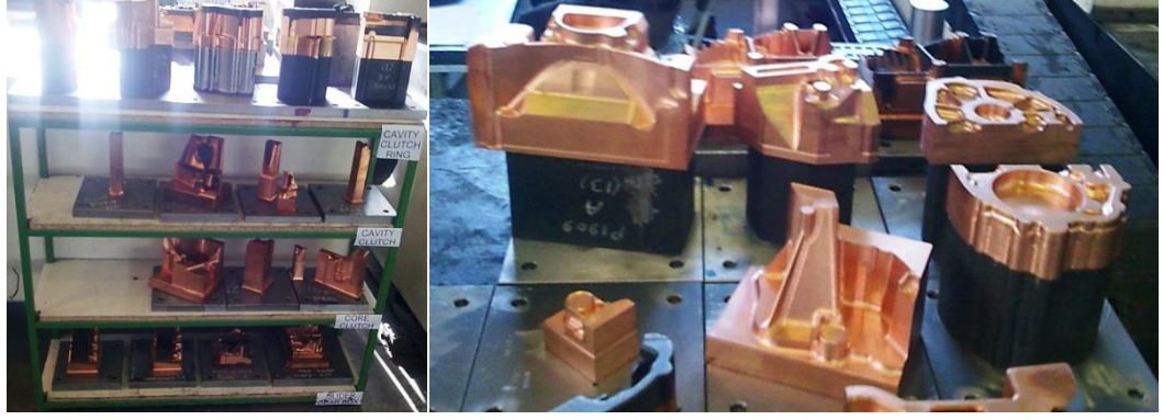
Şekil 6.4: Elektrotlar (Aletler), Debriyaj Mahfazası Kalıbı numunesinin kıvılcımlanmasında kullanılmaktadır.
