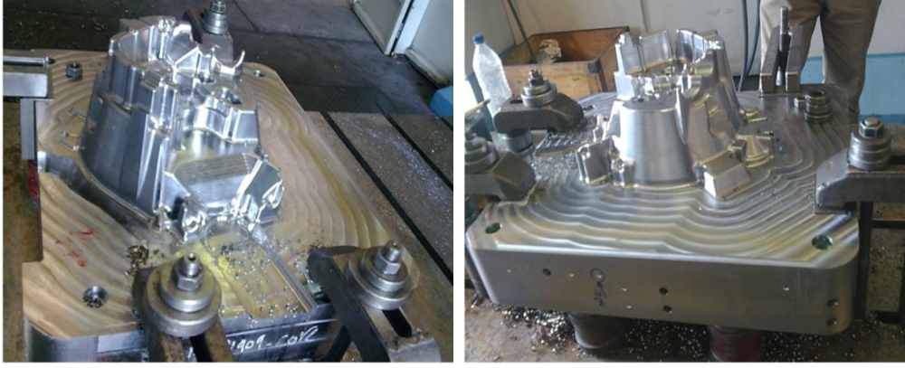
Şekil 6.5: Sabit taraf Debriyaj Mahfazası Kalıbı numunesini frezleme.
