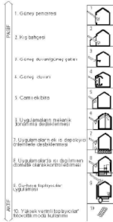
Şekil 42. Pasif Ve Aktif Sistemle Güneş Enerjisinden Yararlanma Prensipleri (Esin, 2002).
