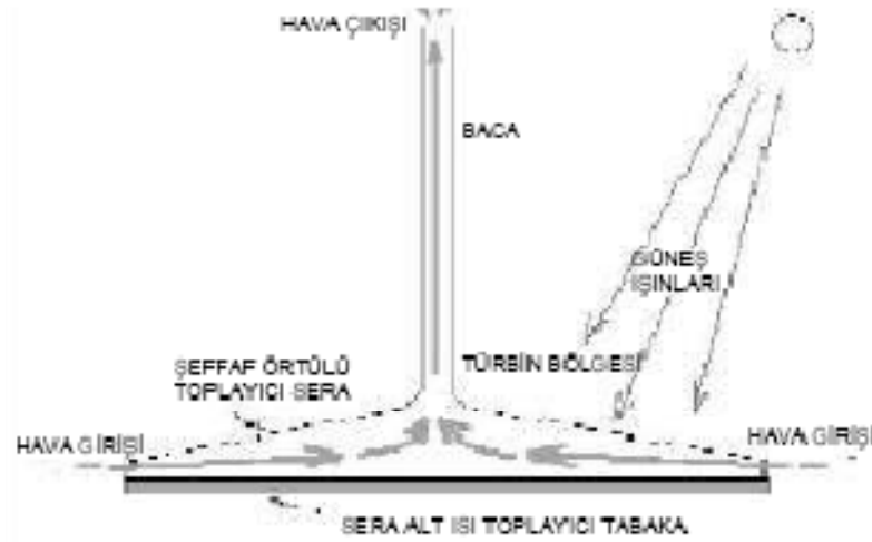
Şekil 36. Güneş Bacası Çalışma Prensibi (Yıldız, 2003)
