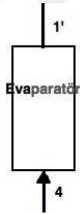
Şekil 5. 5 : Evaporatör Kontrol Hacmi
