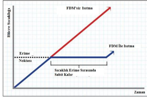
Şekil 2.9 : FDM'nin Batarya Sıcaklığına Etkisi [30].
