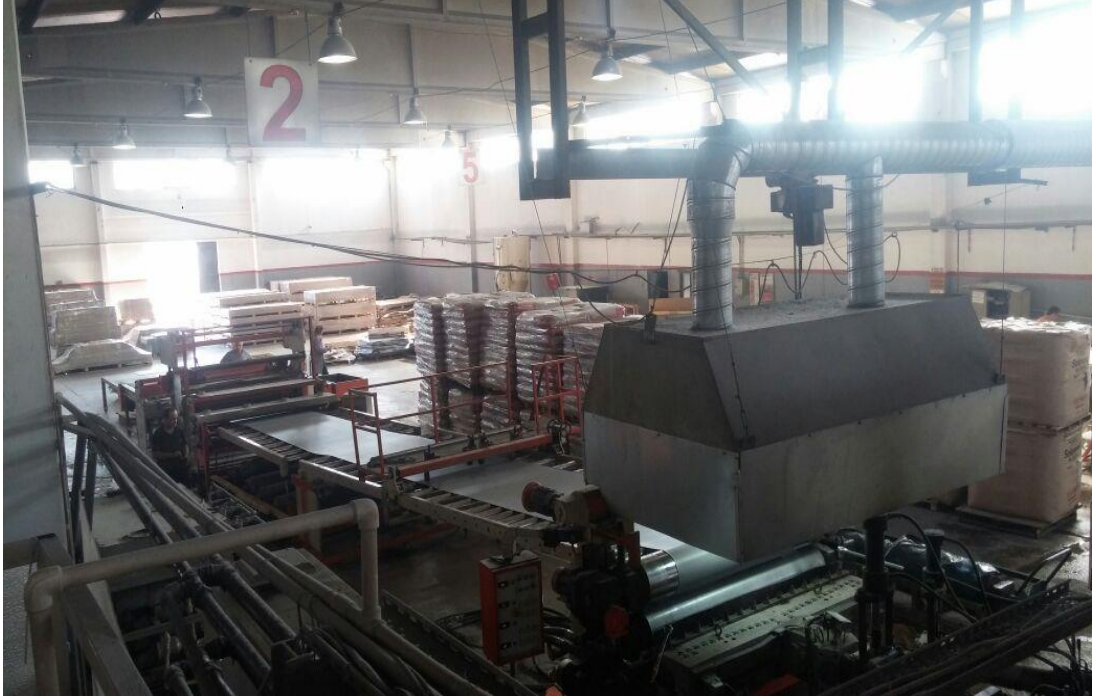
Şekil 5.19: Hattın uzunluğu ve silindir, bıçak yeri
