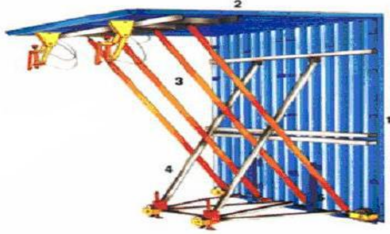
Şekil 12.2: Yarım Kalıpta Elemanlar Gösterilmiştir
