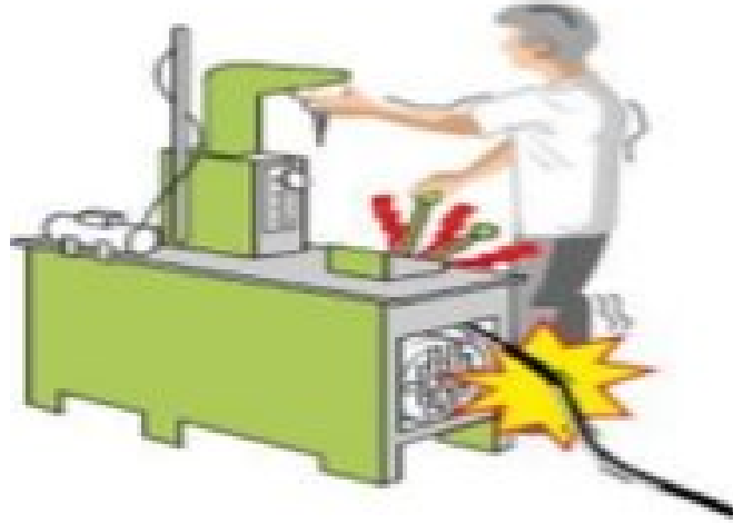
Şekil 4.3: Elektrikle Dolaylı Temas
