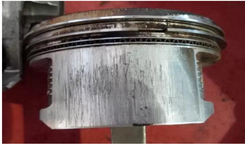
Şekil 4.4: Motor segman aşınması örneği [52]
