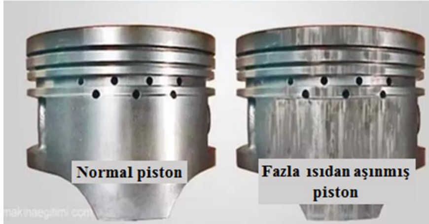
Şekil 4.5: Normal piston ve fazla ısınmadan kaynaklı aşınmış piston örneği [52]
