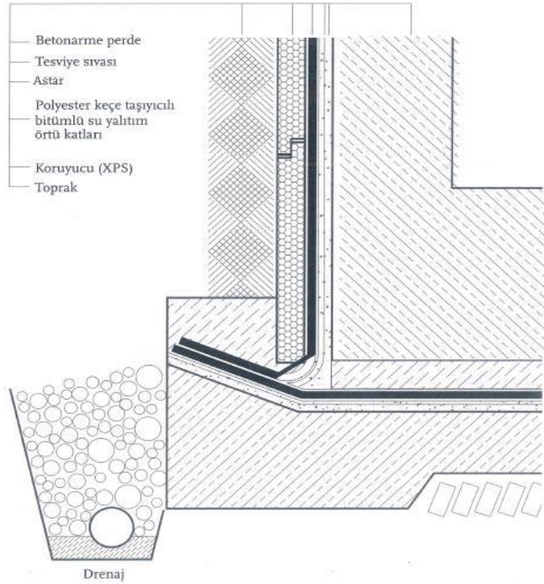
Şekil 42. Basınçlı su için dıştan bohçalama (bitümlü örtü, 2. Kısım)
