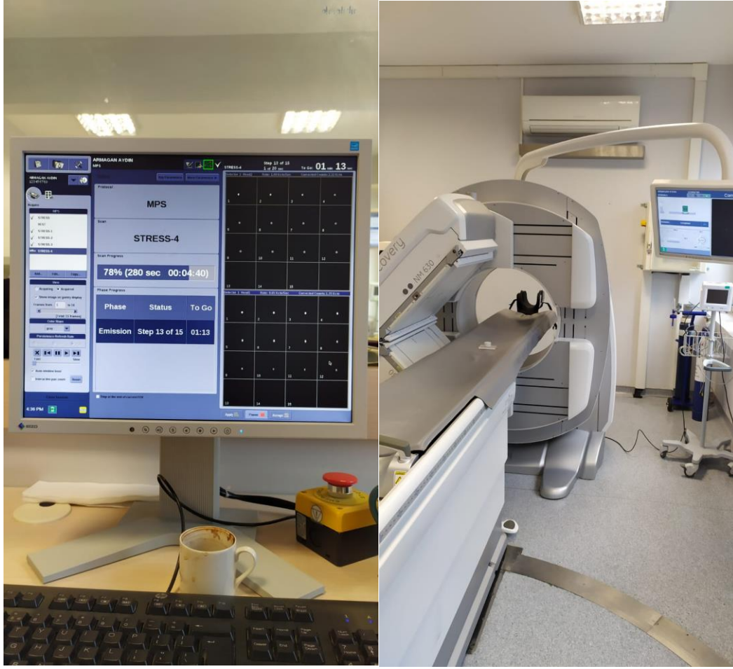
Şekil 10. 13 (A) Ekranda petri kabındaki aktiviteye bağlı sayımlar, (B)Discovery Tandem 630 model NaI(Tl) sintilasyon dedektörlü gama kamerada Petri kabı ile gerçekleştirilen çekim
