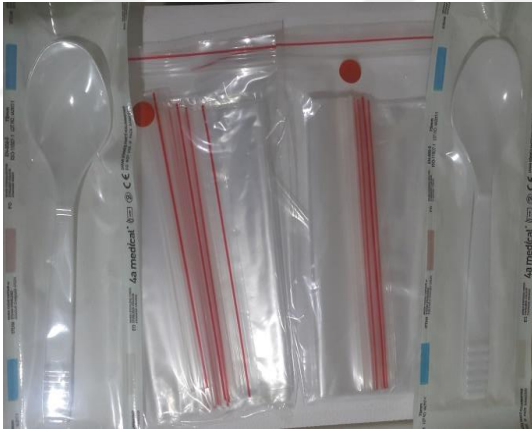
Şekil 3.1: Steril Kaşık ve Gamma Steril Numune Torbası
