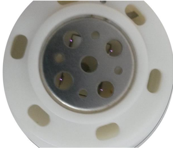
Şekil 6.16 : Ozon üretim anında deşarj kafası görünümü
