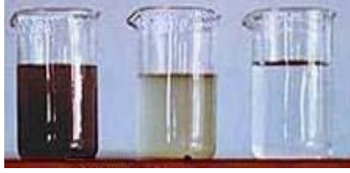
Şekil 1.3 : Atık Su Örneğinde 8,500 Mg/L'den , COD Değerlerinin Ozon İşlemiyle 100mg/L'ye Getirilmesi
