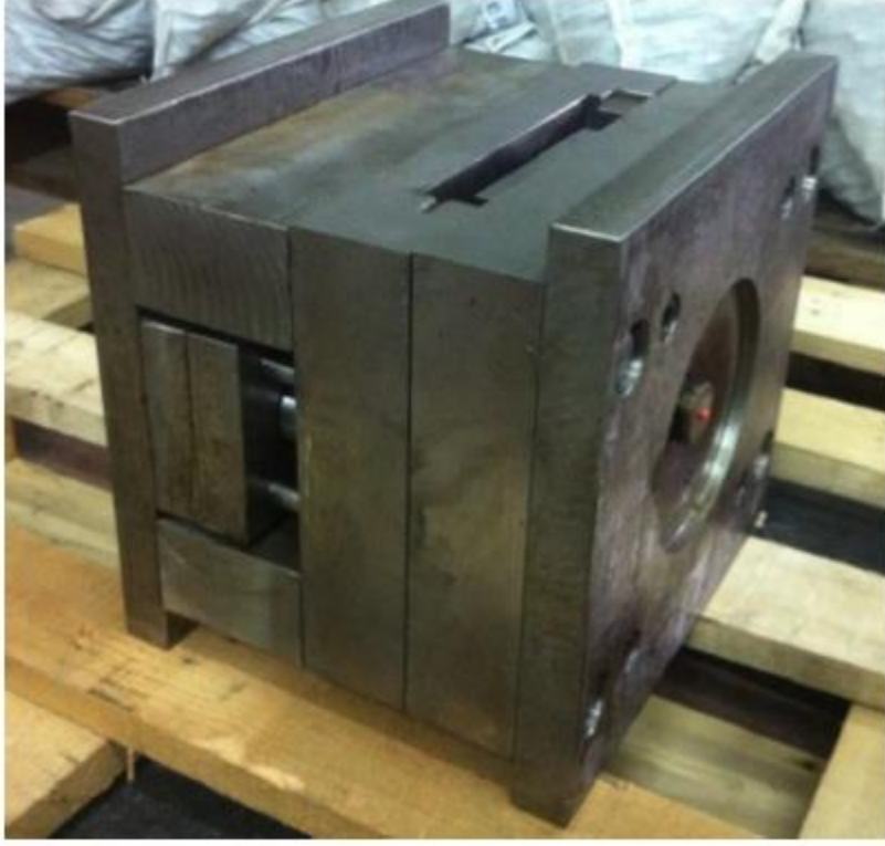
Şekil 6.4 : Kafa plastik Kalıbı
