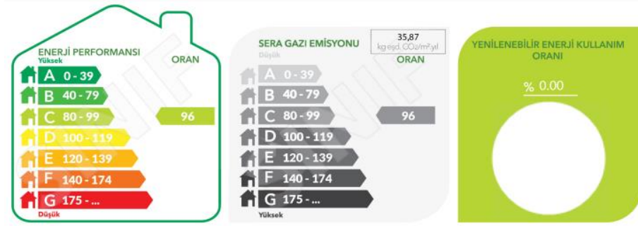
Şekil 39 Eski Bina İyileştirildikten Sonra Enerji Performansı ve Sera Gazı Emisyon Oranlarının EKB Sonuçları
