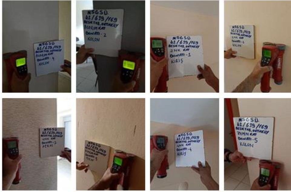
Şekil 38. Hasarsız donatı tespit cihazı ile yapılan kontrollerden örnekler
